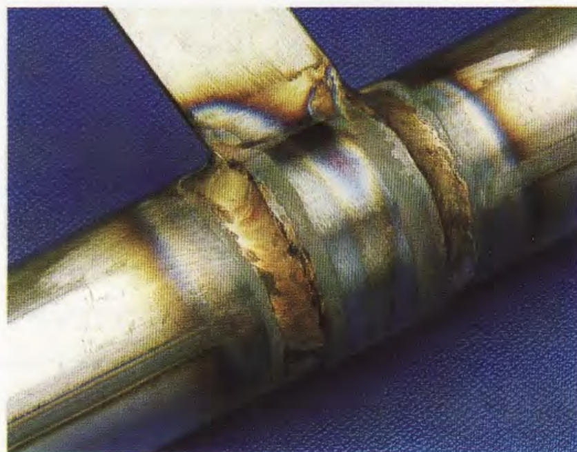
DIL 350 ワイヤーによる溶接例
