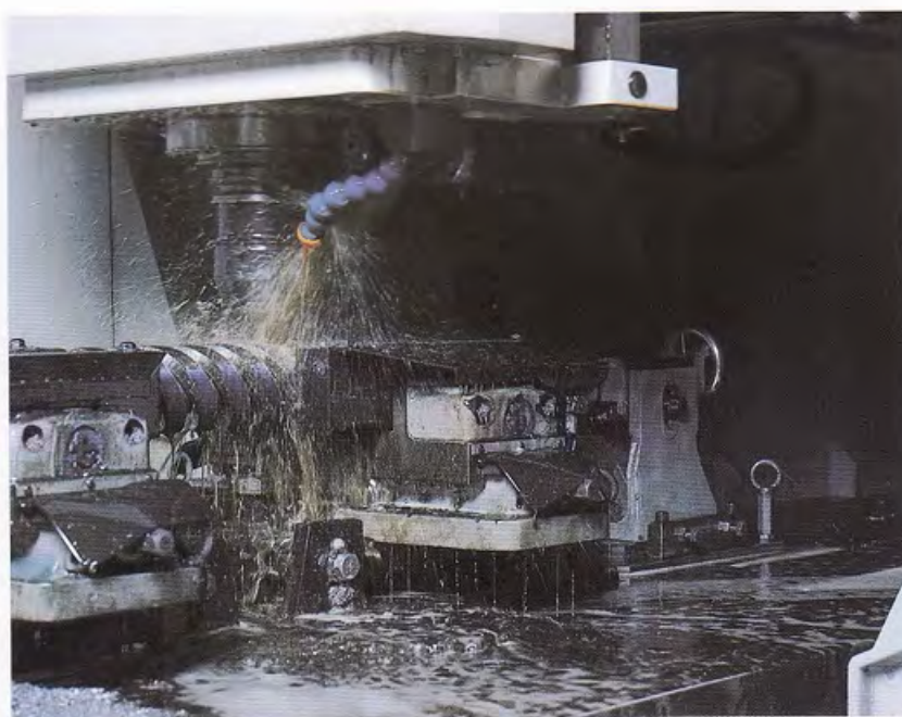
マシニングセンターによる 樹脂押出し用スクリュー加工
